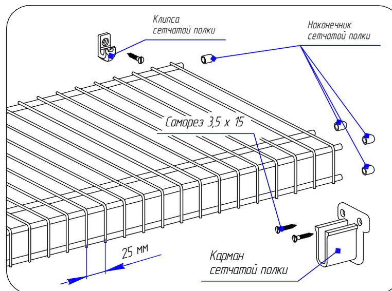
Сетчатые полки режутся по середине между прутками, для установки пластиковых наконечников.
