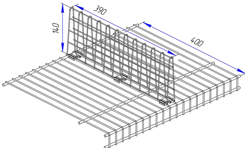
*Делитель сетчатой полки легко крепится к полке с помощью клипсы крепления.*
