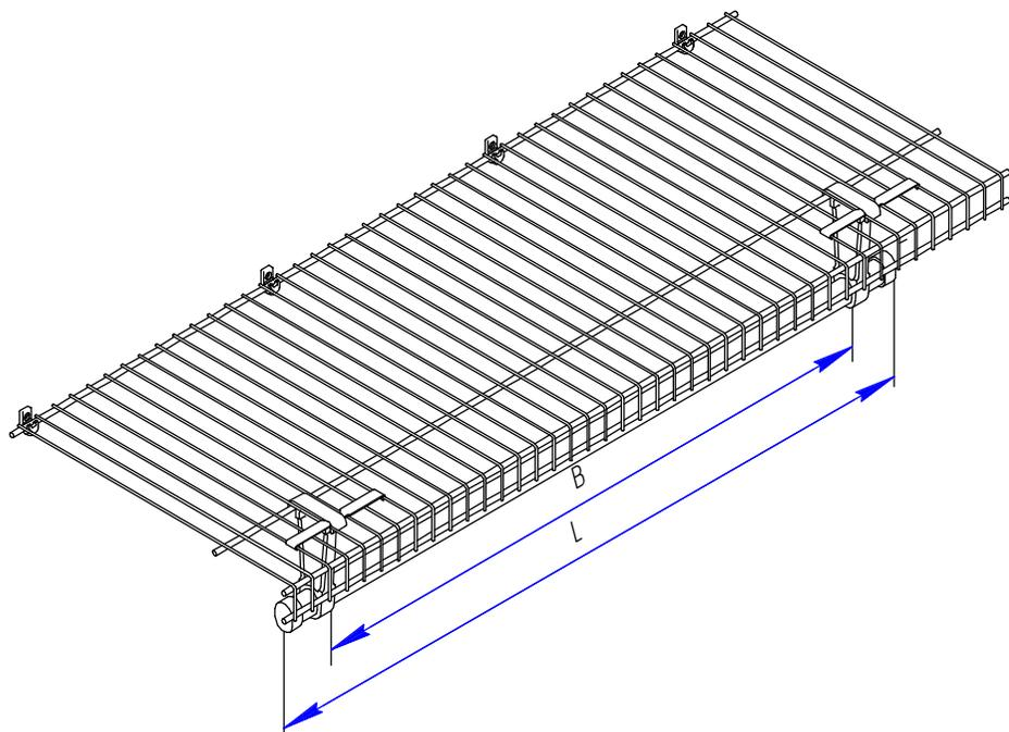
Кронштейн вешала устанавливается на сетчатую полку при помощи лепестка адаптера и жестко фиксируется на ней, исключая его выпадение.
