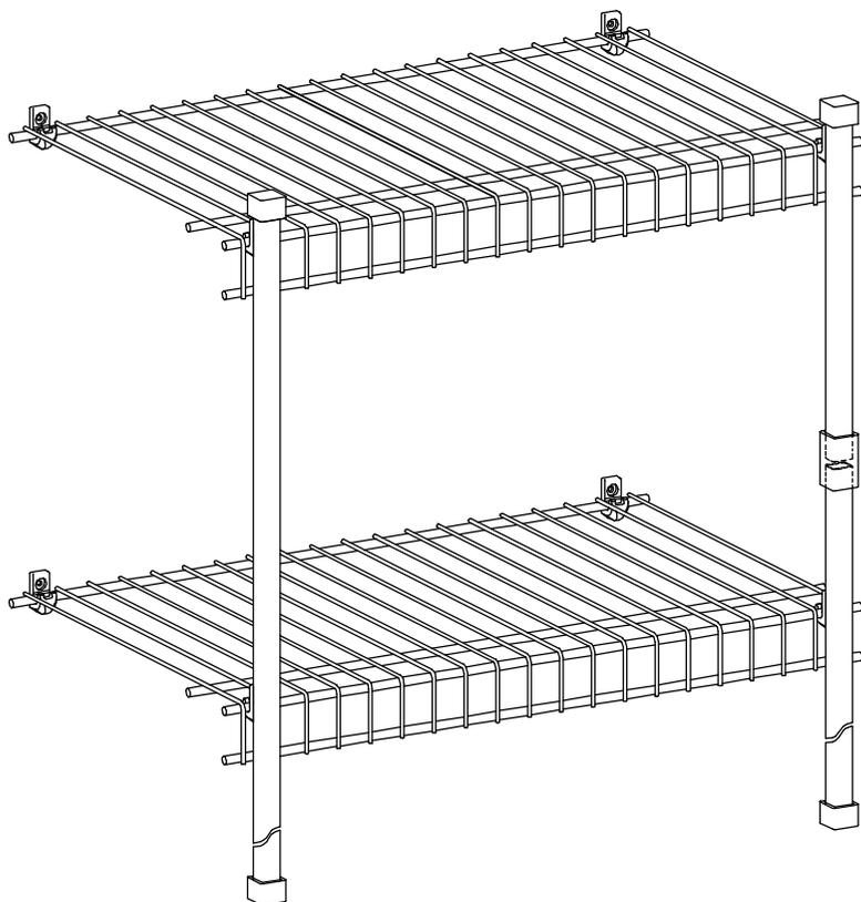
Сетчатые полки режутся по середине между прутками, для установки пластиковых наконечников.
