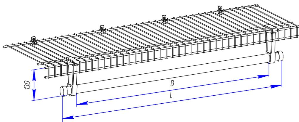
Кронштейн вешала устанавливается на полку без дополнительной фурнитуры и жестко фиксируется на ней, исключая его выпадение.
