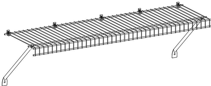
Сетчатые полки режутся по середине между прутками, для установки пластиковых наконечников.
